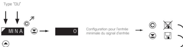
**MIN A** Configuration pour l'entrée minimale du signal d'entrée
