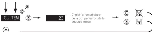
Choisir la température de la compensation de la soudure froide
