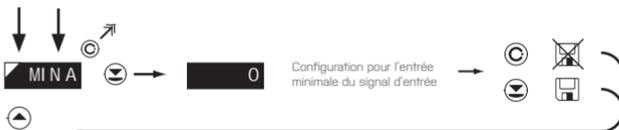
**MIN A** Configuration de l'affichage pour La valeur maximale du signal d'entrée
