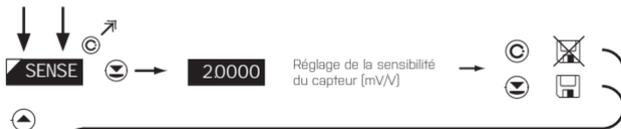
**SENSE** Configuration de l'affichage pour la valeur maximale du signal d'entrée
